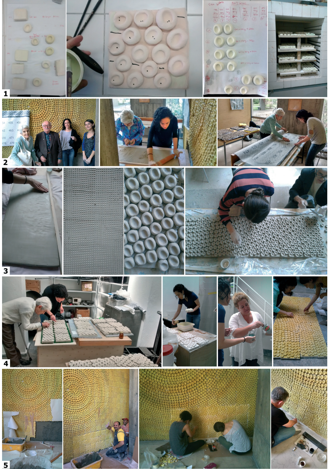
Resim 14. Parçaların yeniden üretiminde farklı aşamalar: (1) çamurun hazırlanması, çamur ve sır deneme parçaları ve deneme fırınlanması, (2) küçülme payına uygun ölçülerin belirlenmesi, plakaların açılması ve kılavuz hizaların belirlenmesi, (3) plakaların ve birimlerin üretilerek uygun şekilde perdahlanması ve biçimlendirilmesi, (4) bisküvi fırınlanması yapılan parçaların daldırma ve püskürtme teknikleri ile sırlanması ve sır fırınlanmasının gerçekleştirilmesi, (5) parçaların duvara yerleştirilmesi ve derze ilişkin çalışmalar (Filiz Diri Akyıldız, Gülüz Korkmaz ve Ömür Bakırer, 2016)
