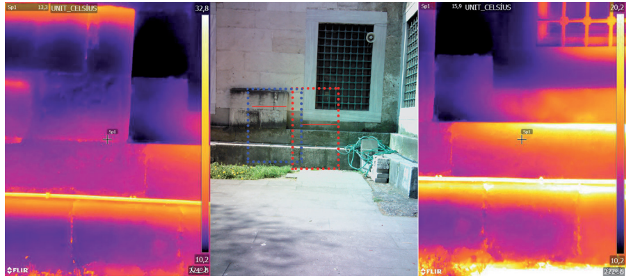
Resim 19. Mart 2016'da gerçekleştirilen KTK ölçümü. Pertev Paşa Camii kuzeydoğu cephesinde UHT sonuçlarında hata veren yağma yapı birimi yüzey sıcaklıkları dağılımı
